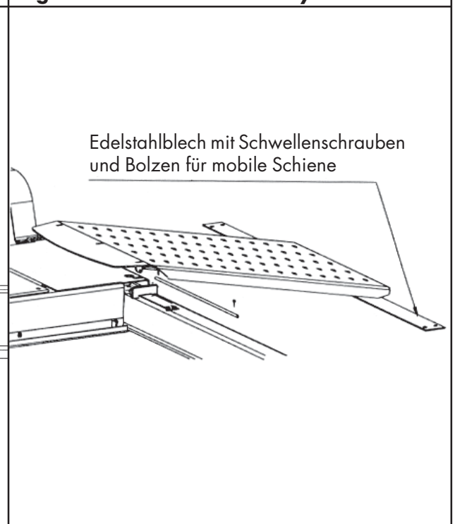
Fig. 14 Montage der Auffahrampen
